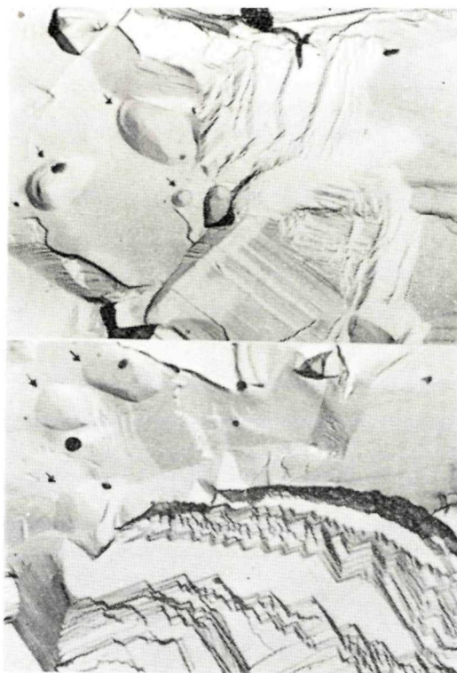
Obr. 1. Zrnný agregát antimonitu s nerovnomerne ohraničenými zrnami, ktoré majú na plochách \{110\} paralelné vertikálne ryhovanie. Typická bloková mikroštruktúra antimonitu so schodovitými útvarmi zvýrazňujúcimi plochy štiepateľnosti je na elektrónovej mikrofotografii v strede. Šípky označujú izometrické reliéfové inklúzie pentagonálno-dodekaedrickej formy veľkosti 1 až 2 mikrometrov. Elektrónová mikrofotografia pozostáva z dvoch záberov. Poproč (Spišsko-gemerské rudohorie, vzorka č. 72). Zväčš. 8000-krát
