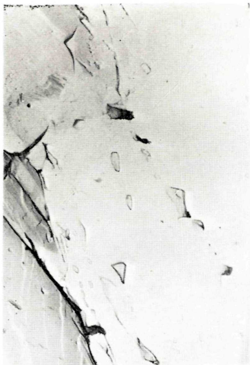
Obr. 7. Mikroštruktúra antimonitu, sčasti bloková, porušená, bez inklúzií (vľavo), s výskytom početných mikroinklúzií rozmerov menších ako 1 mikrometer, ktoré sa miestami zhlukujú do refazcov. Pezinok (Malé Karpaty, vzorka č. 2). Zväčš. 8000-krát
