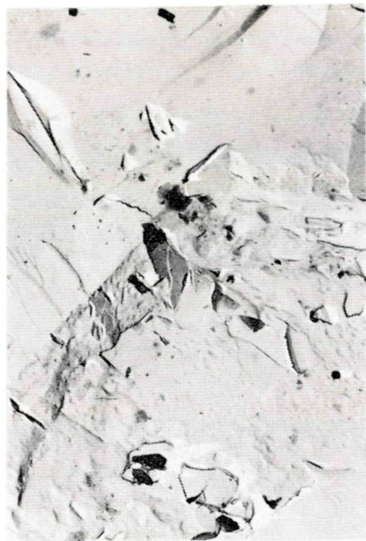
Obr. 3. Bloková mierne porušená mikroštruktúra antimonitu s množstvom mikroinklúzií. Uprostred základnej hmoty antimonitu sú viditeľné zhluky Pb-sulfosolí nepravidelných tvarov. Elektrónová mikrofotografia ukazuje, že v detailoch prebieha proces zameny Pb-sulfosolí za antimonit. Chyžné (Spišsko-gemerské rudohorie, vzorka č. 68). Zväčš. 10 000-krát Fig. 3. Block-like and slightly disturbed antimonite microtexture with numerous microinclusions. Pb-sulphosalt mineral grains of irregular shape are clustered in antimonite groundmass. The electron micrograph demonstrates forthcoming process of the sulphosalt replacement by antimonite. Chyžné locality, Spišsko-gemerské rudohorie Mts., sample No. 68. Magn. \times 10\ 000 .
