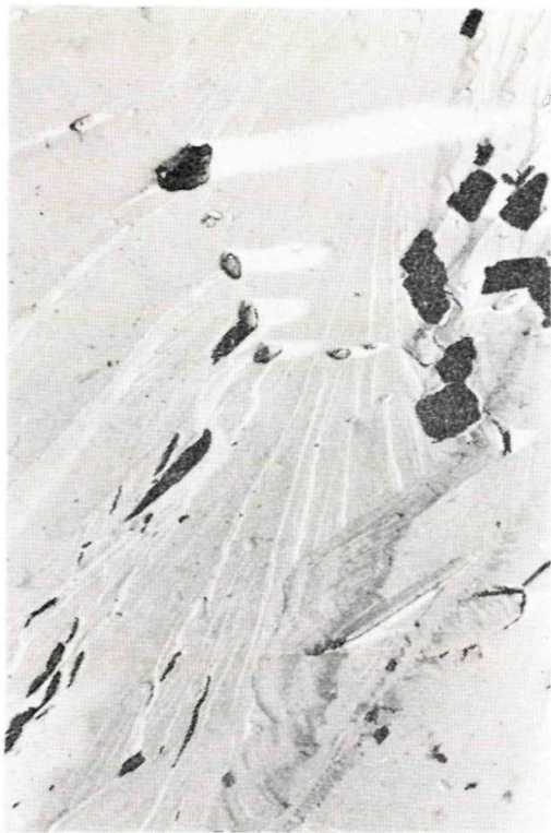
Obr. 6. Mikroštruktúra pomerne čistého antimonitu s nakopeninami inklúzií pyritu a cinabaritu, ktoré sledujú plochu odlučnosti. Plocha je orientovaná v jednom smere a nie je rovná. Cinabarit (kompaktné častice vpravo) bol identifikovaný podľa podobnej mikromorfológie syntetickej rumelky (Cambel et al. 1976). Kremnica (Kremnické vrchy, vzorka č. 3). Zväčš. 7000-krát Fig. 6. Microtexture of relatively pure antimonite with pyrite and cinnabar inclusions clustered along uneven parting plane preferably oriented. Cinnabar (compact particles on the right side) has been identified according to the similar micromorphology of the synthetic cinnabar (Cambel et al. 1976). Kremnica locality, Kremnické vrchy Mts., sample No. 3. Magn. \times 7000 .
