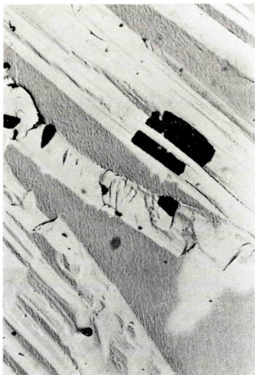
Obr. 8. Typická bloková mikroštruktúra antimonitu so schodovitými útvarmi zvýrazňujúcimi plochu štiepepatelnosti a s typickými mikroagregátmi cinabaritu. Dve kompaktné lištovitité častice predstavujú vytrhnutý materiál v štruktúre základného minerálu. Snímka demonštruje povrchové skulptúry vzniknuté ako dôsledok prírodného naleptania povrchu lomových plôch. Replika ukazuje základnú hmotu antimonitu s mikročasticami neznámeho pôvodu orientovanými v jednom smere. Malé Železné (Nízke Tatry, vzorka č. 51). Zväčš. 15 000-krát
