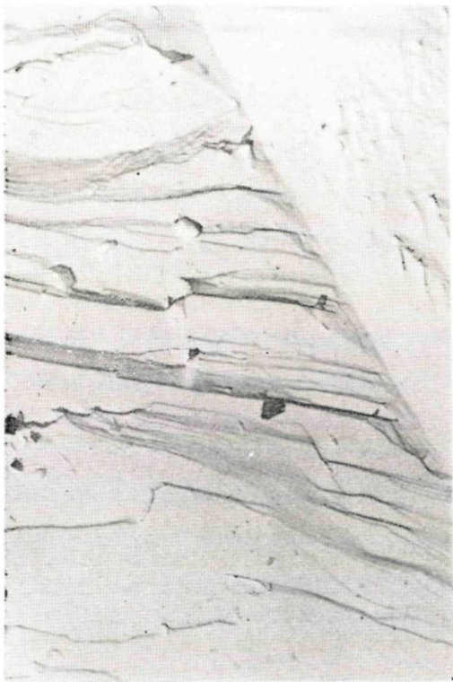
Obr. 5. Bloková celistvá mikroštruktúra antimonitu s výskytom uzavrenín kubickej fázy, ktorá je v relácii k pyritu. Pezinok (Malé Karpaty, vzorka č. 1). Zväčš. 10 000-krát Fig. 5. Block-like massive microtexture of antimonite with cubic phase inclusion occurring in relation to pyrite. Pezinok locality, Malé Karpaty Mts., sample No. 1. Magn. \times 10\,000 .
